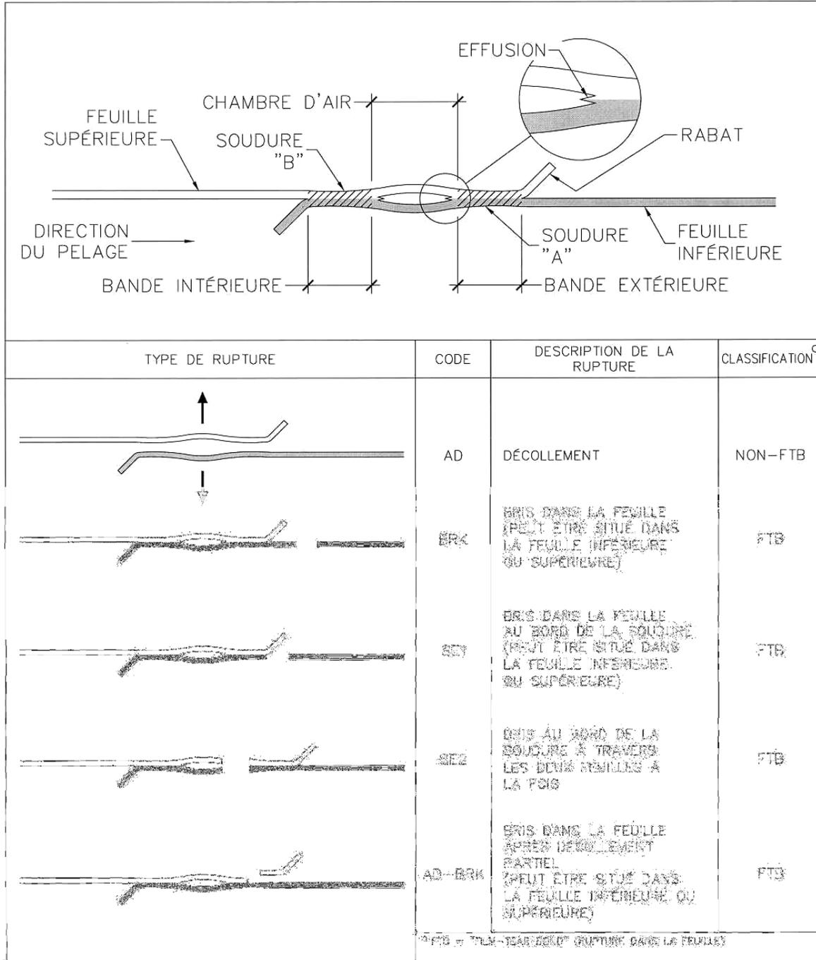
FIGURE 4 – TYPES DE RUPTURE POUR UNE SOUDURE PAR EXTRUSION
